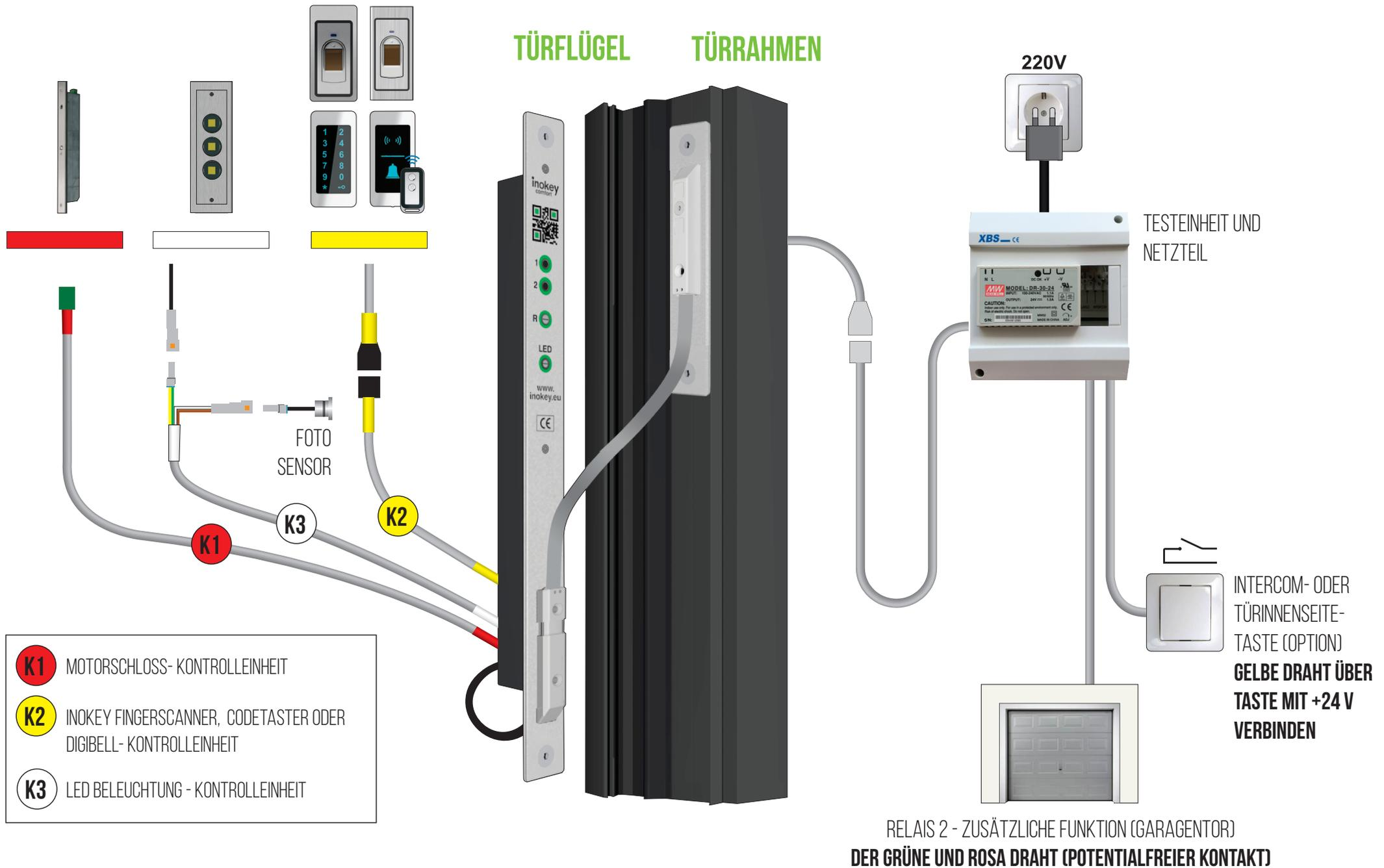
SYNCHRONISIERUNG (KODIERTE VERBINDUNG) FINGERSCANNER UND KONTROLLEINHEIT: TASTE **(R)** - 1 BIS 2 SEKUNDEN LANG DRÜCKEN
